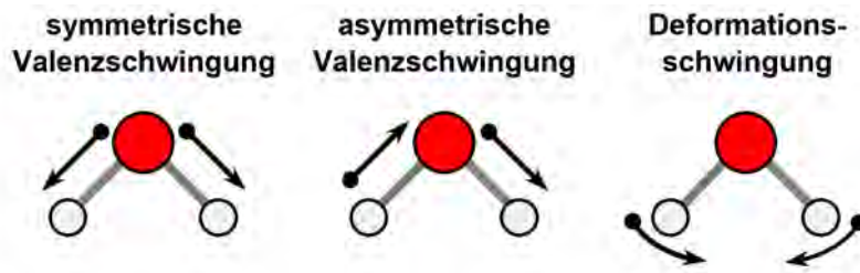
Abbildung 28: Schematische Darstellung der drei Normalmoden eines Wassermoleküls. Unterscheidung in Valenz- und Deformationsschwingungen.
